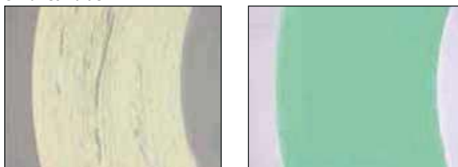
Ilustración 3.4 Observación estereomicroscópica de secciones de tubo con una mala dispersión del pigmento y aditivos
