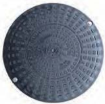
Tapa de cámara de Plástico DN 400 accesible, clase de carga A 15 (1,5 t) incl. seguridad para niños, con 2 tornillos de cabeza hexagonal con arandelas para instalar con una llave de 13 mm.
