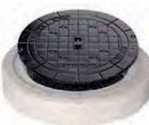
Tapa de cámara combinada, (redonda) DN 400 Hormigón B 125 y hierro fundido (12,5 t) sin ventilación – B 125
