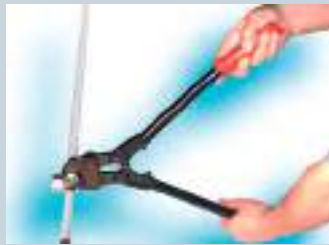
5. Ajuste: Apriete el cilindro de acero al cuerpo de montaje con la prensa hidráulica especial Polysan, abriendo sus brazos alrededor del cilindro y cerrándolos después completamente
