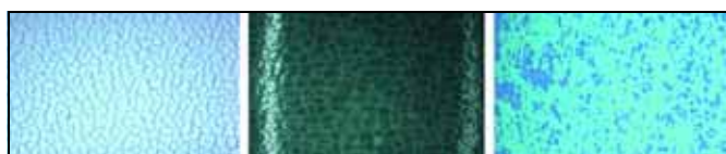
Ilustración 3.2 Ejemplos de la degradación de los patrones observados en las tuberías de PP-R en su superficie interna, expuesta a alta concentración de dióxido de cloro o hipoclorito de sodio
